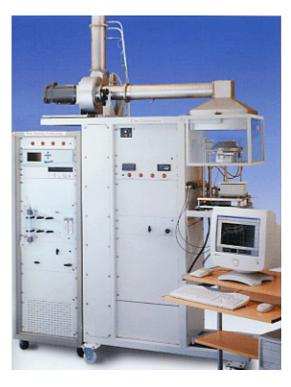
Cone Calorimeter를 사용할 때, analysis rack은 Cone Calorimeter unit과 함께 위치한다. Large Scale Calorimeter의 사용을 위해서 rack이 필요할 때 이 부분은 Cone frame으로부터 분리되고 power에 연결하여 더 큰 calorimeter의 sampling line을 위해 새로운 위치로 이동된다.
