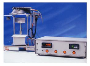
가연성, mass loss 작동에 보다 많은 관심이 있는 사람들 또는 예산이 한정된 사람들을 위해서 FTT는 Cone Calorimeter로부터의 완전한 fire model인 Mass Loss Calorimeter를 제공하고 있다. 적절한 후드 아래서 이 장비를 사용하면 specimen 반응을 관찰하고 mass change를 측정하는 동안에, Cone Calorimeter에서 사용된 것들과 같이 정확한 노출 조절 하에서 user가 열 노출 조사를 실행할 수 있게 해 준다. thermopile을 포함하는 flux가 그 unit에 추가될 수 있다. methane burner
