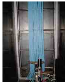
EN 50399 Cable Test Interior detail
