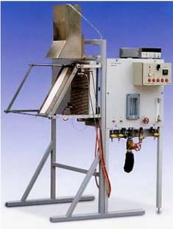
복사패널 불꽃퍼짐장치 (Radiant Panel Flame Spread Apparatus)는 가스로 점화되는 복사열 패널을 이용하여 건축자재용 제품 (ASTM E 162) 및 셀룰러 플라스틱 (ASTM E 365)의 표면 가연성을 측정한다. 복사패널지수 (Index,  $I_s$ )는 불꽃퍼짐과 열방출 인자로부터 결정된다. 이 복사패널지수는 다양한 산업규격, 특히 대량수송기관 산업 (buses and trains)에서는 필수 파라미터이다. FTT의 복사패널 불꽃퍼짐 장치는 시스템을 매우 용이하게 사용할 수 있도록 되어 있다.
